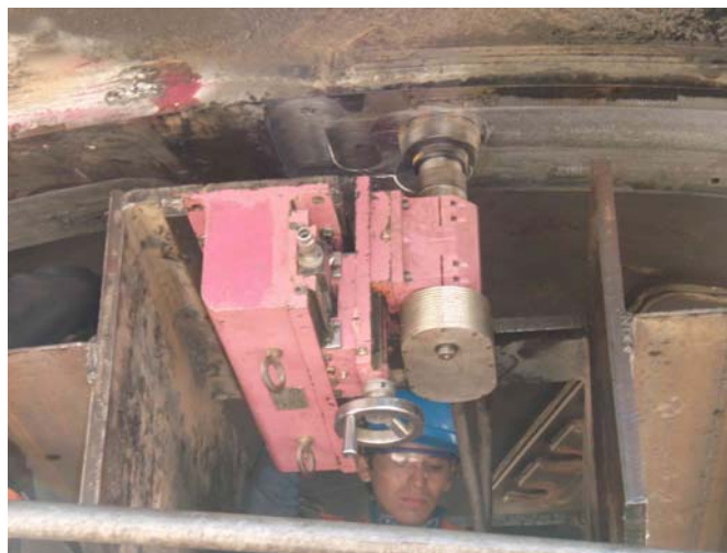
Fuente: PC231609.JPG Primeras pasadas con la fresa
