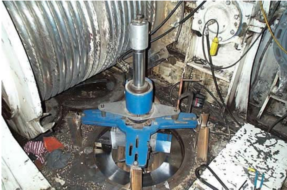
Foto: Barrenado y refrentado del agujero del pin central de una pala P&H 4100
